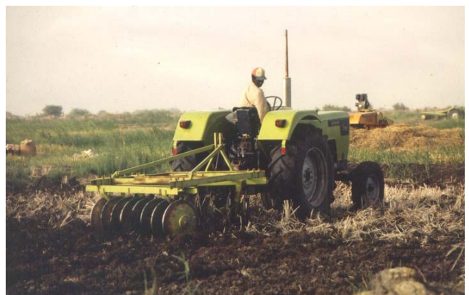
Travail du sol en rizière irriguée avec un covercrop porté. Sénégal. Cliché : Havard M., 1991
