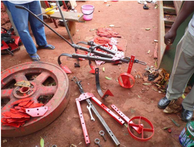
Fabrication de houes manga par un artisan, Burkina Faso. Cliché : Side C.S., 2013
