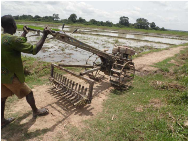
Motoculteur chinois avec roues cages et herse rotative, Burkina Faso. Cliché : Side C.S., 2013
