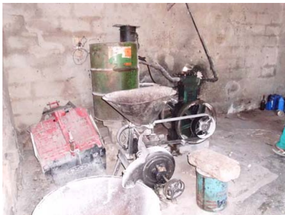
Moulin à meules à céréales, Togo. Cliché : Havard M., 2012
