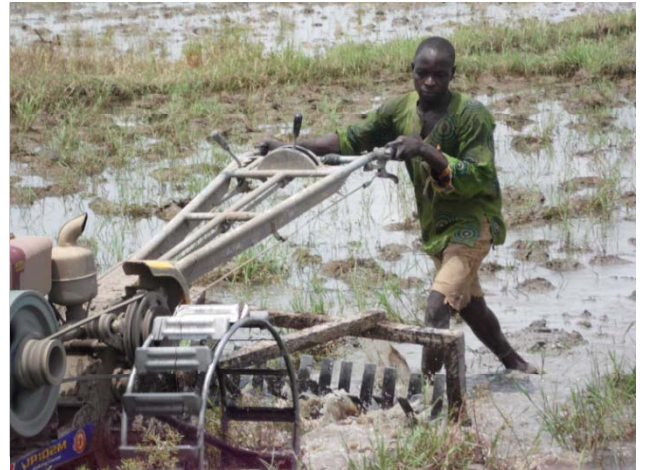
Mise en boue rizière avec motoculteur chinois, Burkina Faso. Cliché : Side C.S., 2013
