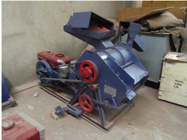
Egreneuse à maïs de fabrication chinoise, Burkina Faso. Cliché : Havard M., 2013
