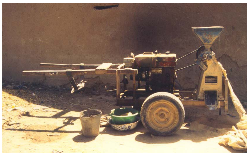
Décortiqueur à riz à moteur, déplacé par la traction animale, Office du Niger, Mali. Cliché : Havard M., 2003
