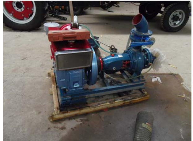
Motopompe de fabrication chinoise de 150 m 3 /H, Burkina Faso. Cliché : Havard M., 2013
