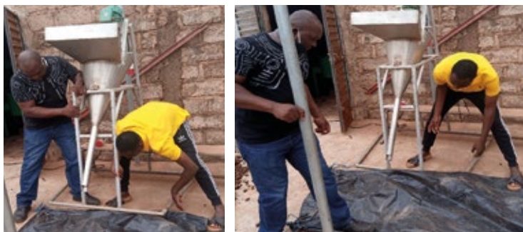
Préparation de l'espace et installation de la briqueteuse
